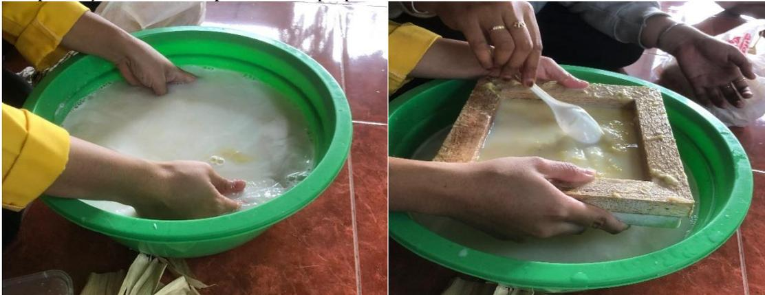
**Gambar 5. Proses Pencetakan *Pulp***
