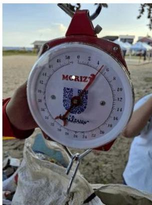
**Gambar 9.** Neraca gantung untuk menimbang karung-karung sampah.
