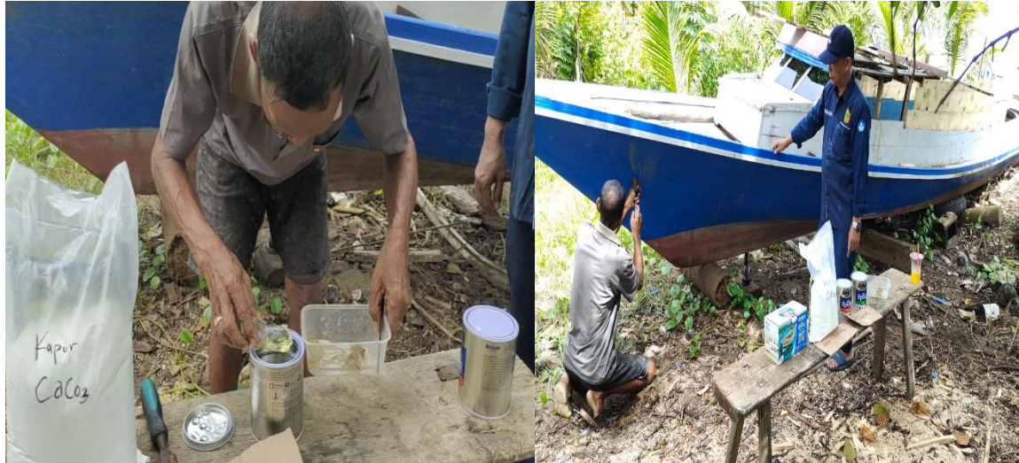
Gambar 4 Dr. Mukmin Muhammad sedang memberikan arahan dan bimbingan kepada nelayan dalam proses pengeleman perahu menggunakan kapur \text{CaCO}_3 yang dicampur dengan Lem Epoxy.
