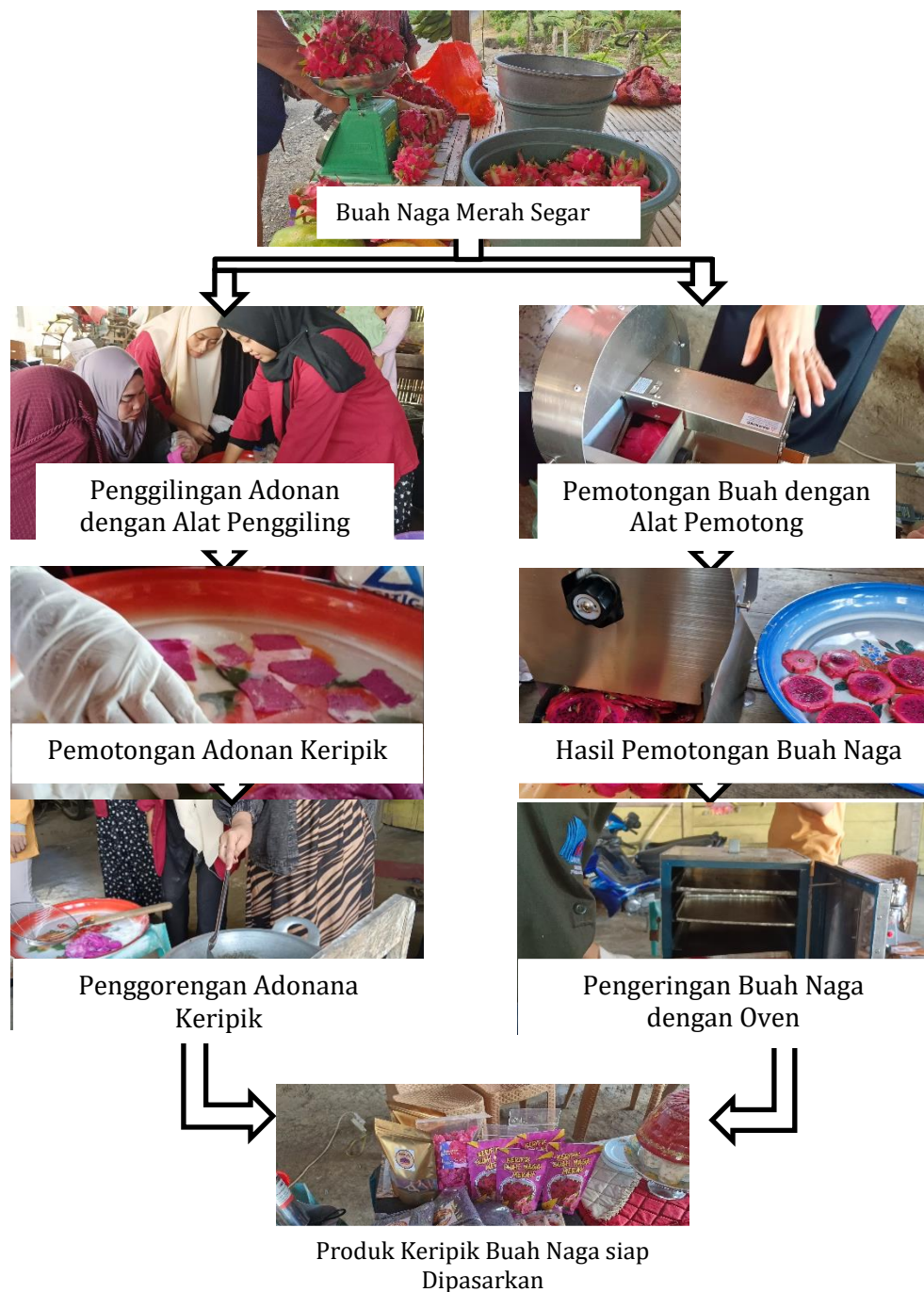
Gambar 3. Tahapan Pembuatan Keripik Buah Naga dengan Menggunakan Teknologi Tepat Guna
