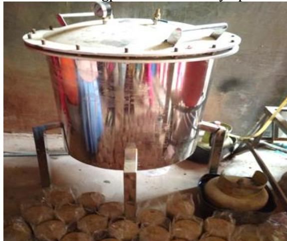
Gambar 6. Pemasukkan Media Tanama untuk Proses Sterilisasi
