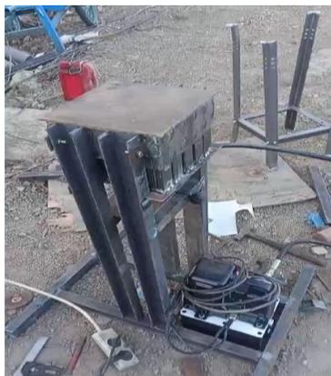
Gambar 1. Mesin Pencetak Briket Semi Otomatis
