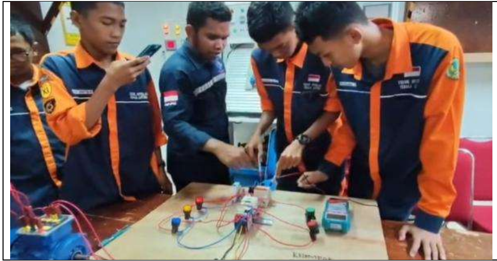
Gambar 4. Merakit komponen-komponen rangkaian instalasi motor listrik 3 fasa versi otomatis (rangkaian dikendalikan oleh hp android)
