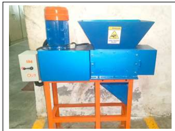
Gambar 1. Tampak depan mesin pencacah sampah organik sebagai pakan magot.
